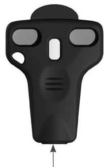
Zona en la cual se sitúa el imán para la puesta En/Fuera de servicio del collar
