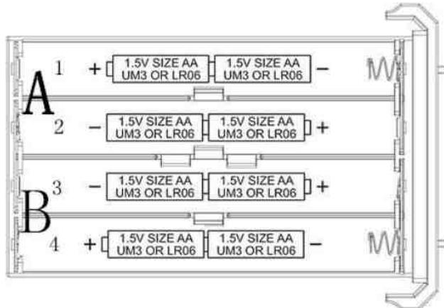
Die Betriebsspannung der Fotofalle beträgt 12V. Für den Betrieb der Fotofalle sind 8 AA-Batterien notwendig.
