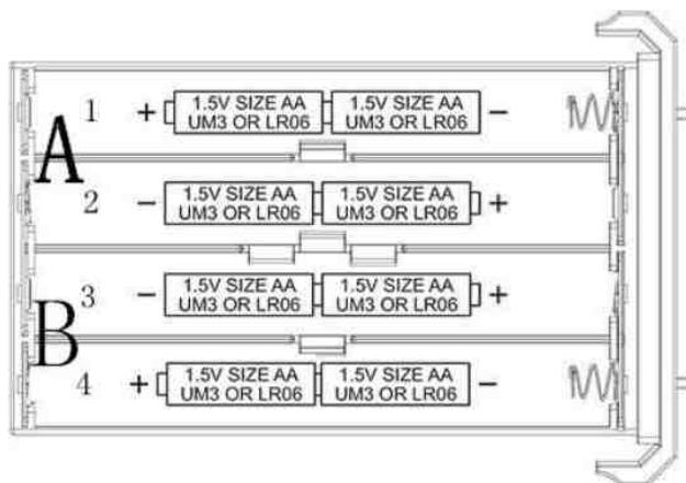
La tensión de funcionamiento de la cámara es de 12 V. Para alimentar la cámara se necesitan 8 pilas AA.
