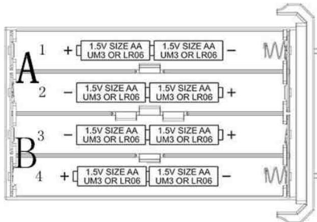
La fototrappola necessita di 8 batterie AA. Per inserire le batterie premere il pulsante
