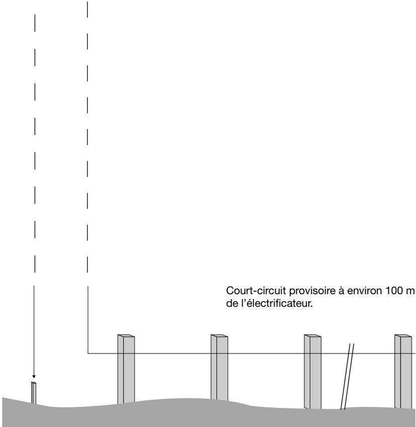
Court-circuit provisoire à environ 100 m de l'électrificateur.
