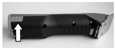
Fig. 7 Engate da bateria
