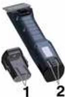
1. Die Kontakte der Schermaschine (1) und des Akkus (2) auf Fremdkörper und Verschmutzung überprüfen.
