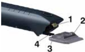
Die Schermaschine dient zum Scheren von Hunden, Katzen, Rindern und Pferden. Als Schneidwerkzeuge werden zwei kammartige Messer verwendet. Das der Haut zugewandte Untermesser (3) ist feststehend und auf dem Messerscharnier (4) befestigt. Das Obermesser (2) wird gegen dieses quer hin- und herbewegt. Das Obermesser wird mit Hilfe eines Schwenkhebels (1) in Bewegung versetzt.
