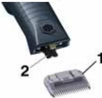
2. Scherkopf (1) auf das geöffnete Messerscharnier (2) stecken.
